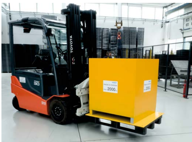
Prova di carico dinamico. - Dynamic load test.
